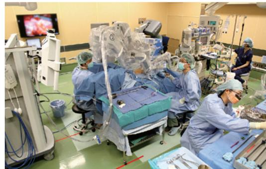
作する鉗子が多関節で人間の手以上に自由な動きをします。さらに、術者が実際に6 cm動かしても鉗子は2 cmしか動かない(動きが1/3に縮小して伝えられる)仕組みで、手振れ防止機能もあり、繊細で正確な操作が可能になります。
